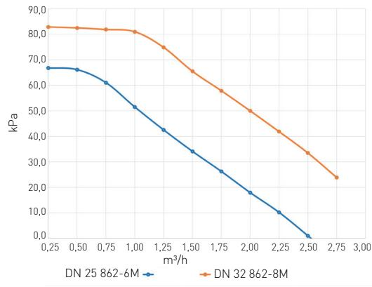
**LK 861 - PUMP GROUP WITH DIRECT SUPPLY | PUMPENGRUPPE MIT DIREKTVERSORGUNG | GROUPE DE POMPES AVEC ALIMENTATION DIRECTE | GRUPPO POMPA CON ALIMENTAZIONE DIRETTA | PUMPPURYHMÄ SUORASYÖTÖLLÄ | PUMPGRUPP MED DIREKTFÖRSÖRJNING**
